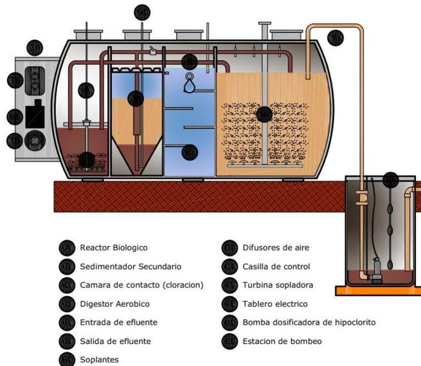
**Figura 6. Planta depuradora compacta.**
